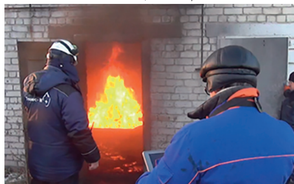
Огневые испытания макета помещения с большим количеством ГЖ
