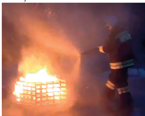
Тушение ручным малорасходным пожарным краном
