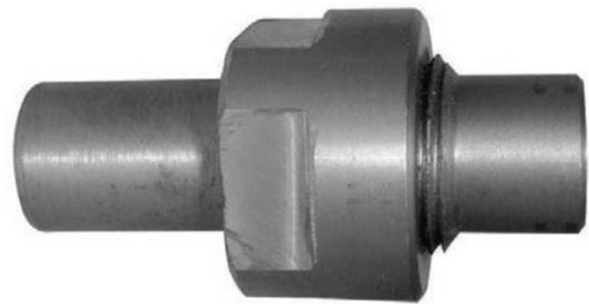
Данный тип соединений предназначен для сборки трубопроводов, работающих при давлении до 20 МПа.
