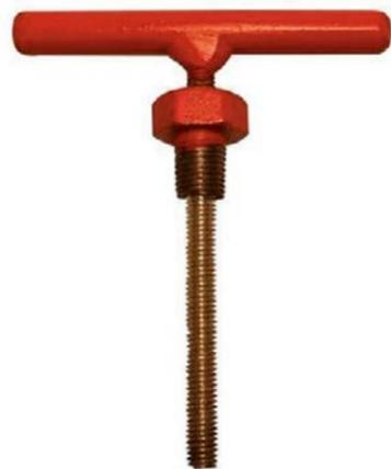
Ключ для заправки МГП предназначен для принудительного открытия запорного клапана запорно-пускового устройства (ЗПУ) путём отжатия поршня через верхнюю крышку. Это позволяет заправить модуль через выходной штуцер при помощи зарядного устройства.
