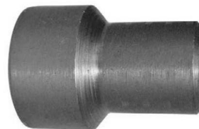
Патрубок для СДУ предназначен для монтажа на трубопровод и установки в него сигнализатора давления СДУ-М с целью получения сигнала о прохождении огнетушащего вещества при пуске системы. Способ монтажа – приварка.
