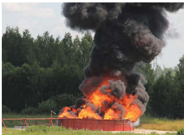
Рис. 4. Горение нефтепродукта в резервуаре при испытании № 1
