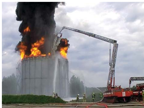
Рис. 1. Применение автомеханической лестницы для тушения пожара в РВС
